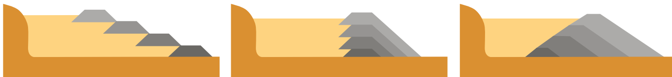
Figur 3. De tre grundläggande konstruktionsprinciperna för höjning av dammkrön vid kapacitetsutbyggnad vid en gruvdammanläggning; inåthöjning, uppåthöjning samt utåthöjning.
